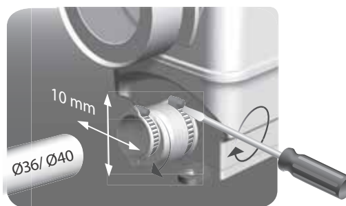
Fig. 35 Højde- og sideopretning mulig ved brug af Ø36/40 tilgangsrør
