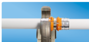
1. Sett på verktøy Pressbakken føres på pressmuffen mot den fargede stoppringen.
